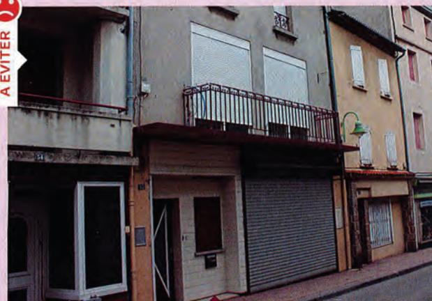
Une superposition d'aménagements malheureux banalisent la rue et la rendent peu attractive : volet roulant et caissons apparents, changement d'usage avec transformations disparates, matériaux inappropriés, rupture de l'alignement...
