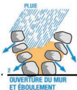
2 OUVERTURE DU MUR ET ÉBOULEMENT
